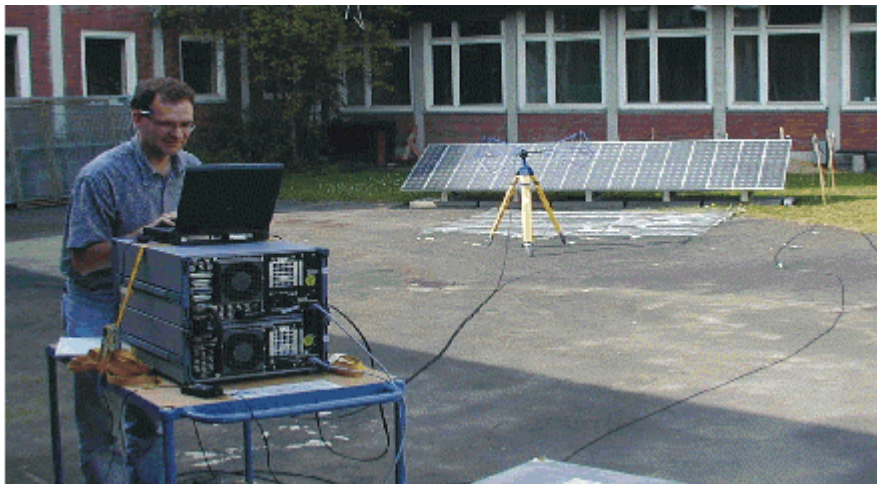
Bild 6 Messung der elektromagnetischen Abstrahlung eines PV- Generators
